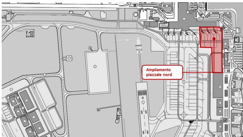
Figura 2-3 Ampliamento piazzale nord
