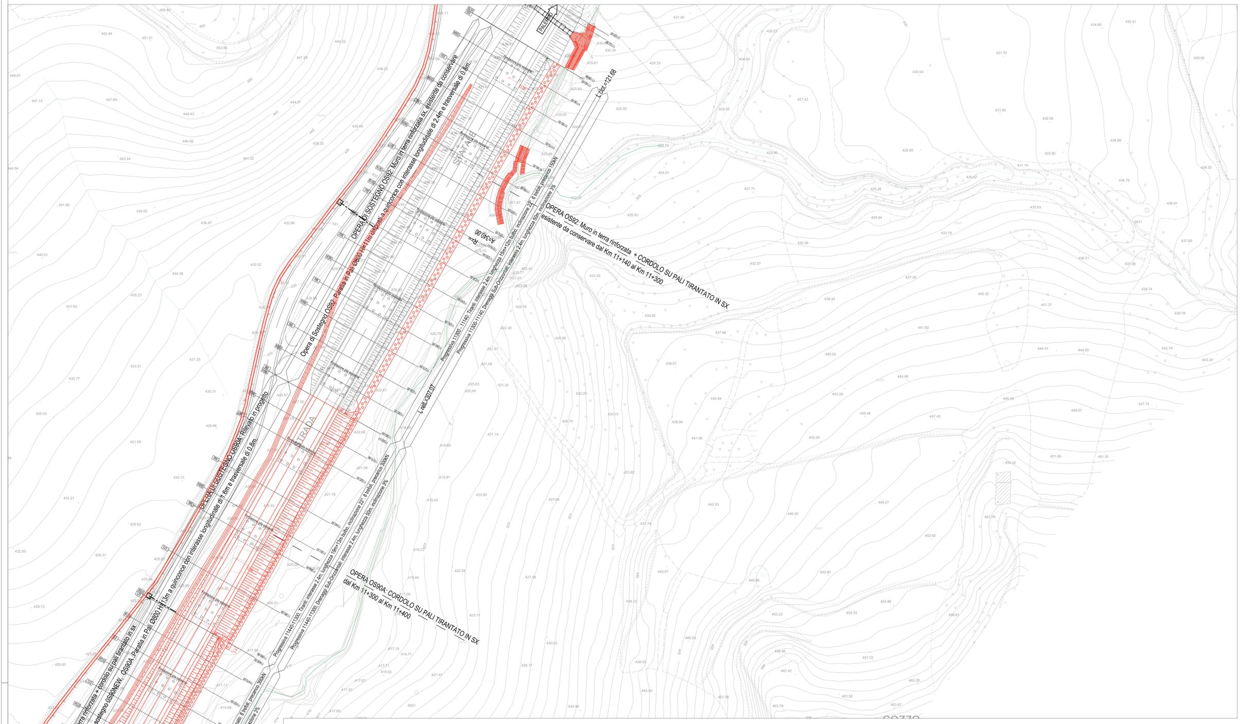
OPERA DI SOSTEGNO OS90NEW: Muro in terra rinforzata + cordolo su pali tirantato in sx OPERA DI SOSTEGNO OS90A: cordolo su pali tirantato in sx OPERA DI SOSTEGNO OS92: Muro in terra rinforzata + cordolo su pali tirantato in sx
