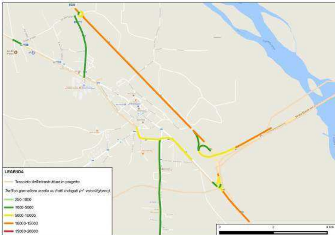
Figura 76: tratti viari con traffico superiore ai 10.000 veicoli/giorno (Strada Provinciale di Ceresole n.460 e Strada Statale di Castellamonte n.565 in corrispondenza dell'abitato di Salassa.)
