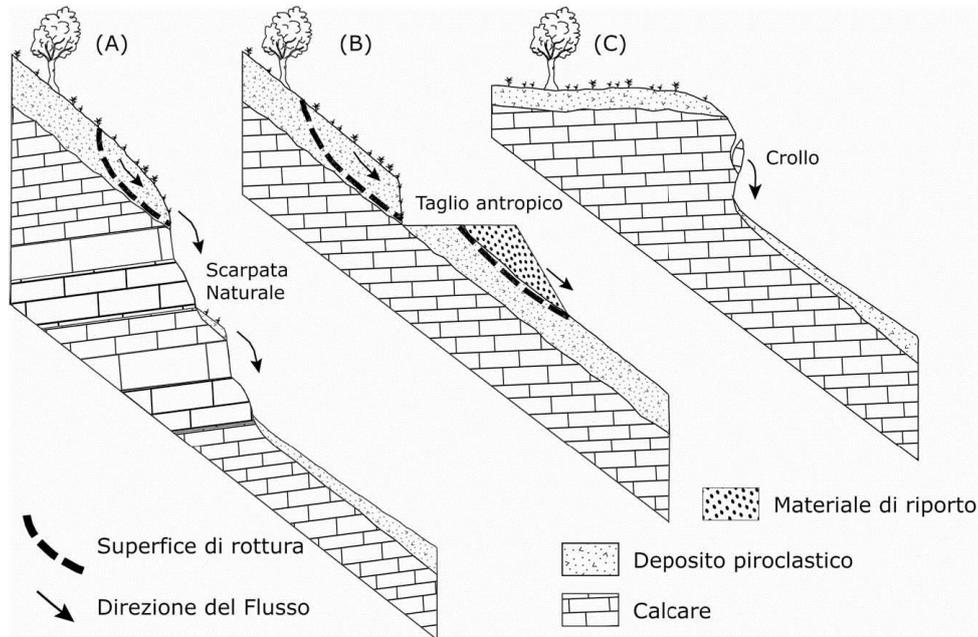
**Figura 11 – Sezioni schematiche lungo un versante carbonatico ricoperto da piroclastiti: A) meccanismo di innesco in corrispondenza di una scarpata naturale; B) meccanismo di innesco in corrispondenza di un taglio antropico; C) meccanismo di innesco in seguito ad un crollo (da Revellino et al. 2006).**
