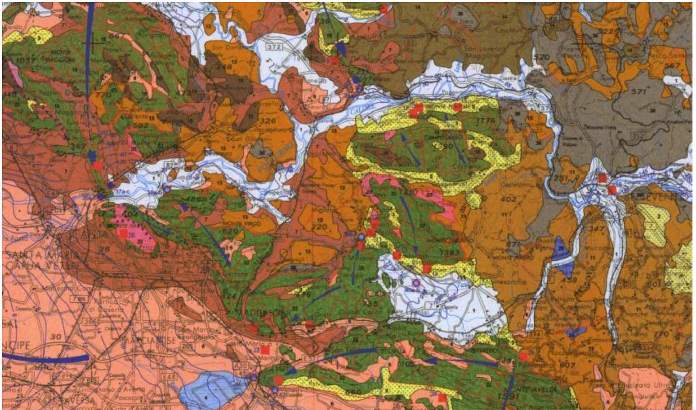
**Figura 13 – Stralcio della Carta idrogeologica dell'Italia Meridionale, con indicazione delle principali sorgenti e direttrici di flusso (da Celico et al. 2007).**
