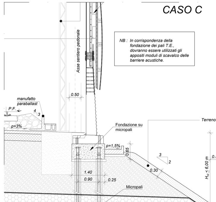
NB : In corrispondenza della fondazione dei pali T.E., dovranno essere utilizzati gli appositi moduli di scavalco delle barriere acustiche.
