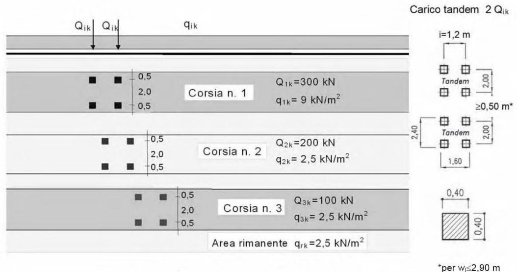
**Figura 2.** Schema di carico 1 (dimensioni in metri)
