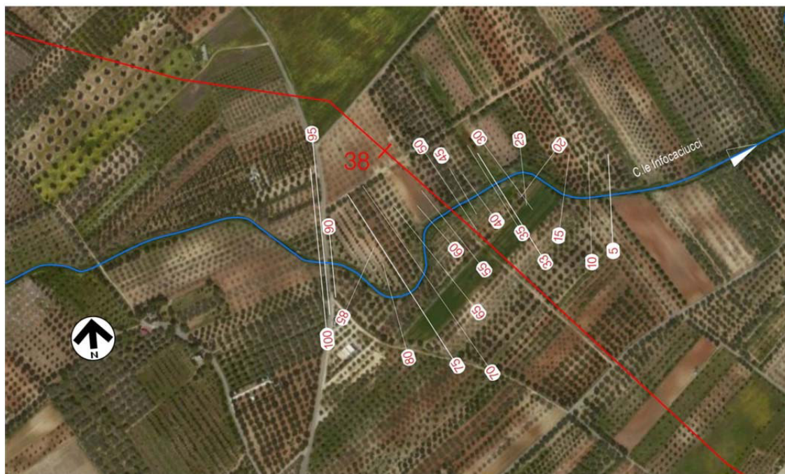
Fig.6.3/A: Tratto del canale analizzato con indicazione delle sezioni studiate
