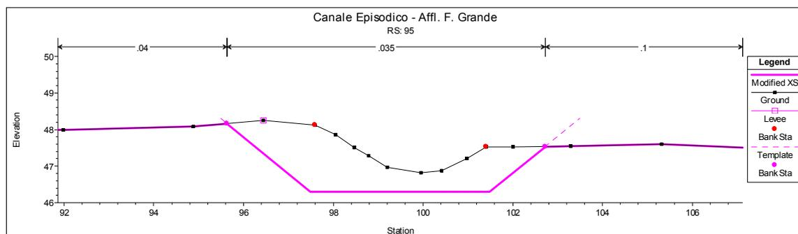
Fig. 5.4/B: Schematizzazione della sezione riprofilata.
