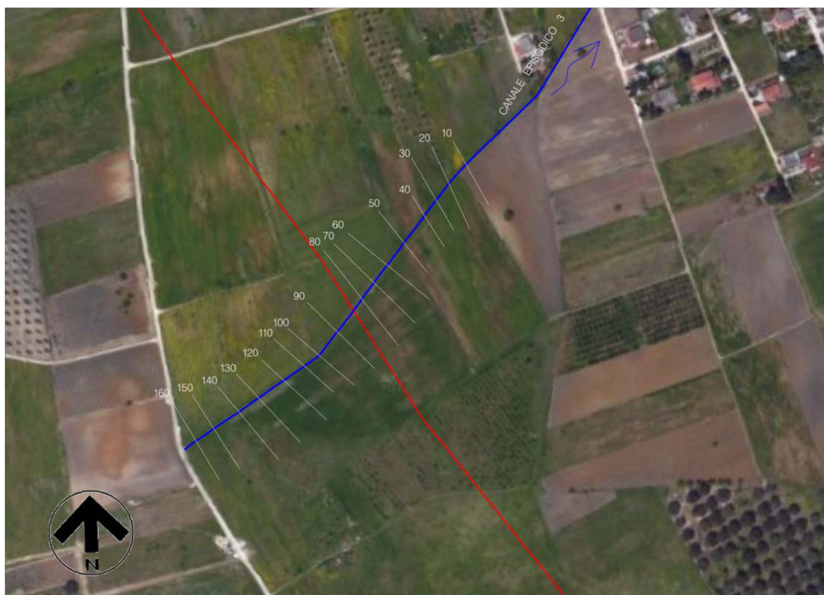
Fig.5.3/A: Tratto del canale analizzato con indicazione delle sezioni studiate
