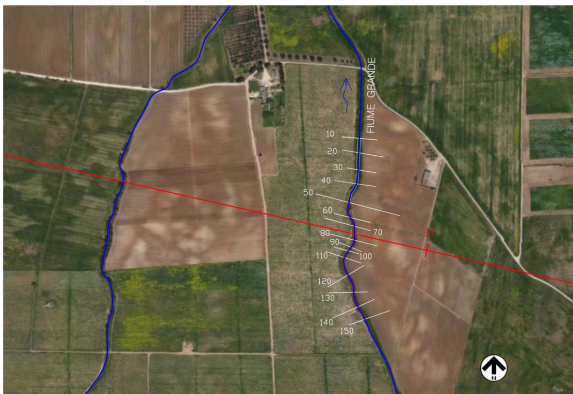
Fig.5.4/A: Tratto del canale analizzato con indicazione delle sezioni studiate
