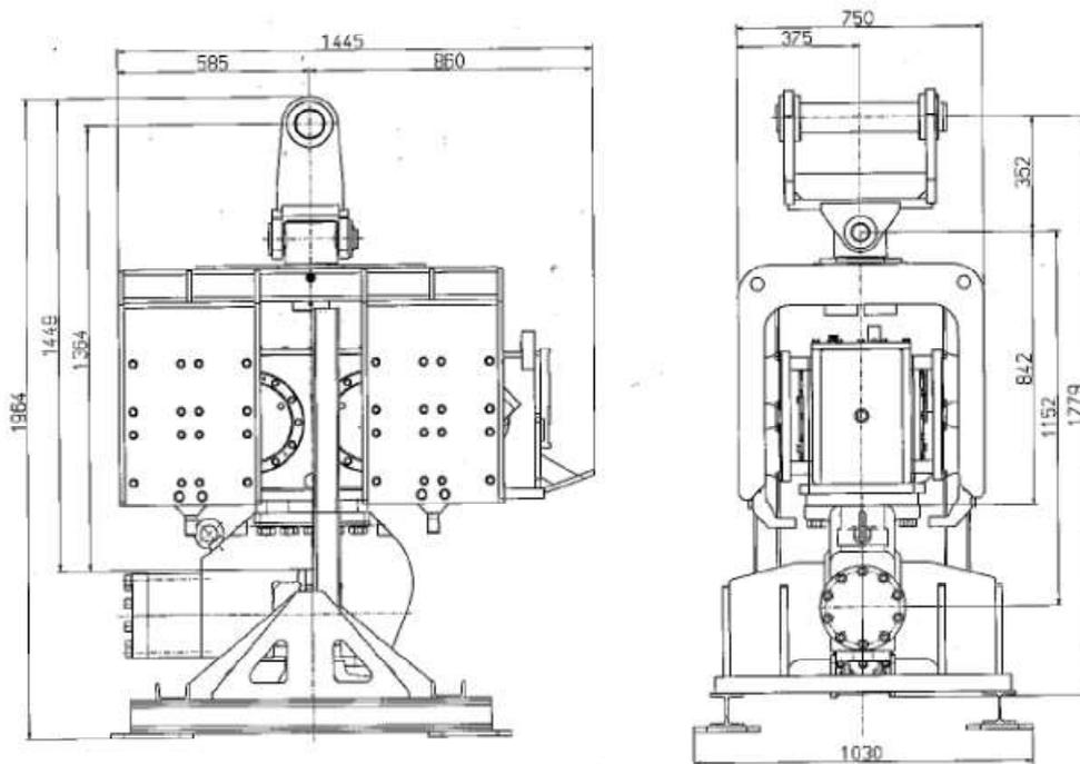
Il vibratore viene montato sul braccio di un escavatore idraulico; qui di seguito un'immagine esemplificativa dell'infissione di palancole con l'utilizzo del vibroinfissore.
