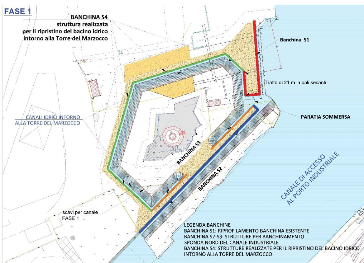
Nella figura a chiarimento, riportata sopra, la struttura realizzata per la formazione del bacino idrico intorno alla Torre del Marzocco è la banchina S4 realizzata in palancole metalliche con gargami impermeabili (vedi TAVOLA 3 già depositata). La struttura per banchinare la sponda del canale industriale e permettere il conseguente allargamento del canale da circa 100 m a 120 m,
