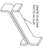
Sistema portante di ancoraggio di due lastre contigue. Due piattine metalliche vengono accostate e ripiegate in versi opposti alle estremità in modo da trattenere separatamente i bordi di due lastre contigue.
