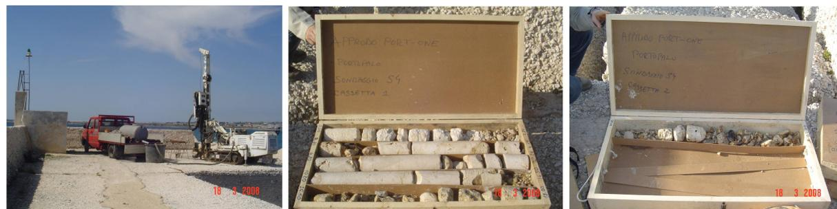
**Figura 16 – Risultati del sondaggio effettuato nella parte terminale del molo**
