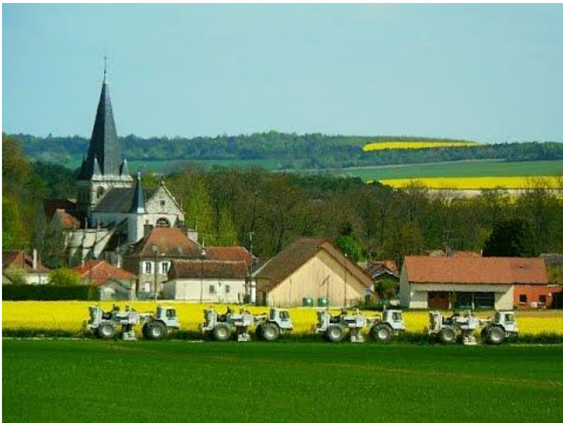
Figura 8 - Esempio di utilizzo di Vibroseis in prossimità di beni architettonici
