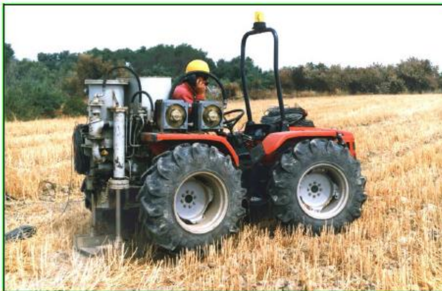
Figura 2 - Vibroseis leggero montato su mezzo agricolo operativo in area appenninica
