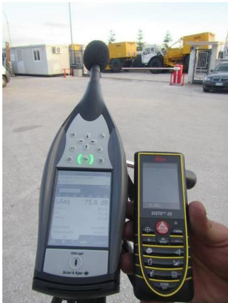
Misura trasversale allineamento vibratori: 30 m - 75.8 dB
