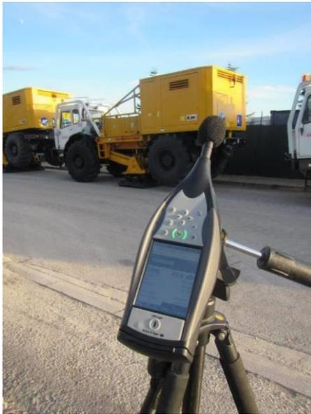
Misura trasversale allineamento vibratori: 10 m – 85.0 dB
