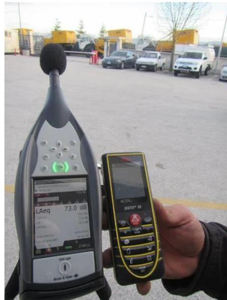
Misura trasversale allineamento vibratori: 40 m - 73.0 dB
