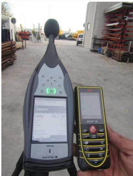
Misura trasversale allineamento vibratori: 60 m - 68.3 dB
