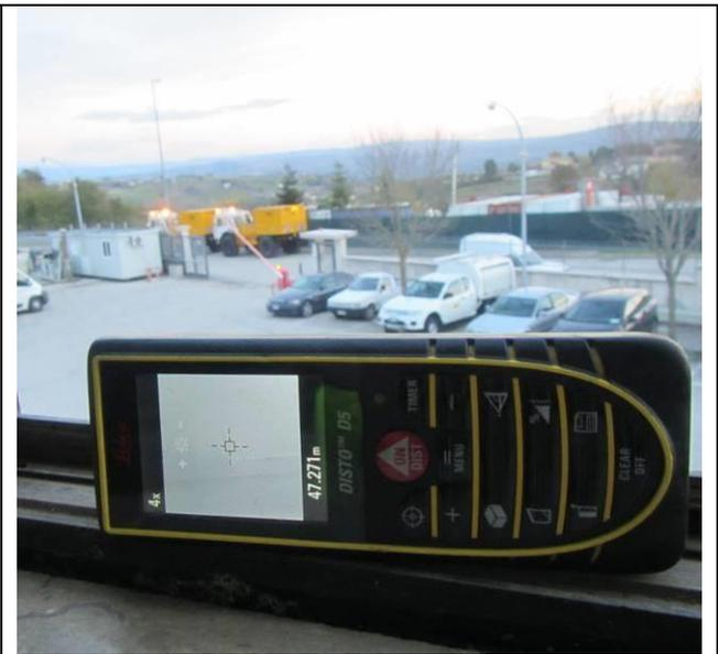
Misura trasversale allineamento vibratori: 10 m –
