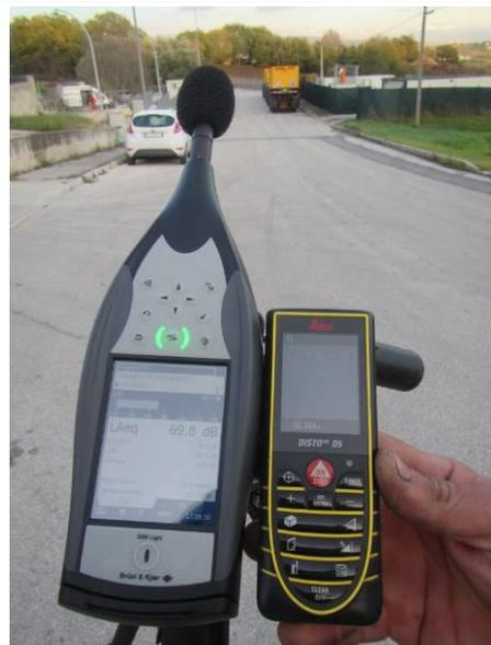
Misura longitudinale allineamento vibratori: 50 m – 69.9 dB
