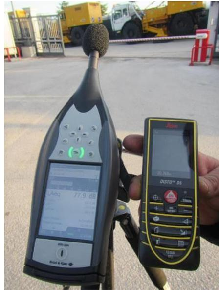
Misura trasversale allineamento vibratori: 20 m - 77.9 dB
