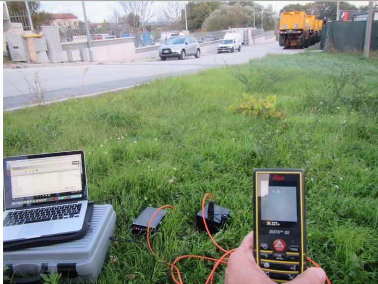
Misura longitudinale allineamento vibratori: 30 m - TERRENO
