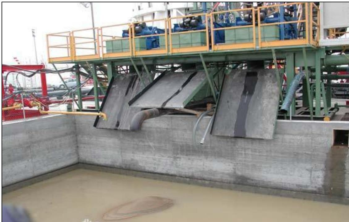
**Figura 4.3: Scarto e Raccolta Detriti e Fango di Perforazione**
