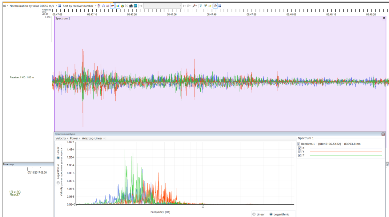
Figura 6. Esempio di tracce acquisite sulla stazione 1-Di, per circa 80 secondi, con relativa analisi di frequenza.
