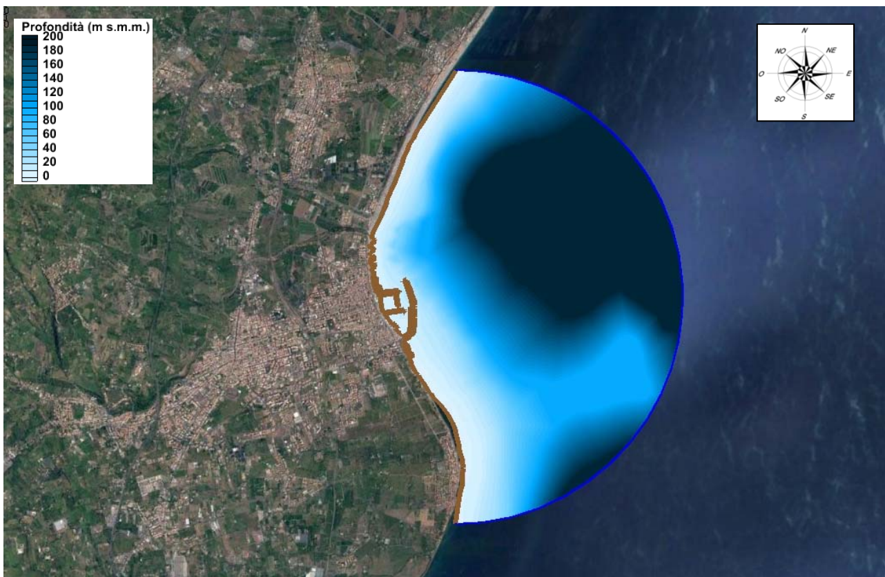
Figura 7-2 Dominio di calcolo impiegato nello studio della penetrazione del moto ondoso e della risonanza in configurazione attuale
