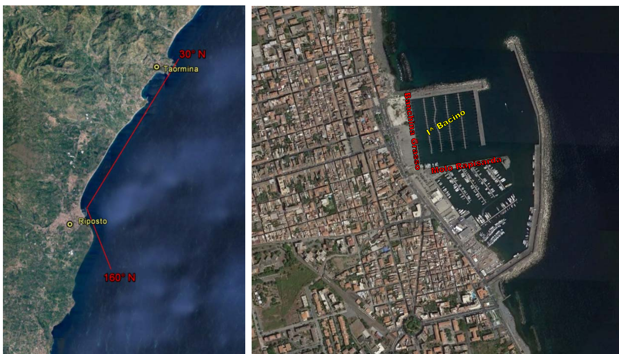
Figura 2-1 Inquadramento geografico del paraggio: settore caratteristico di traversia (a sinistra) e immagine satellitare del porto (a destra)
