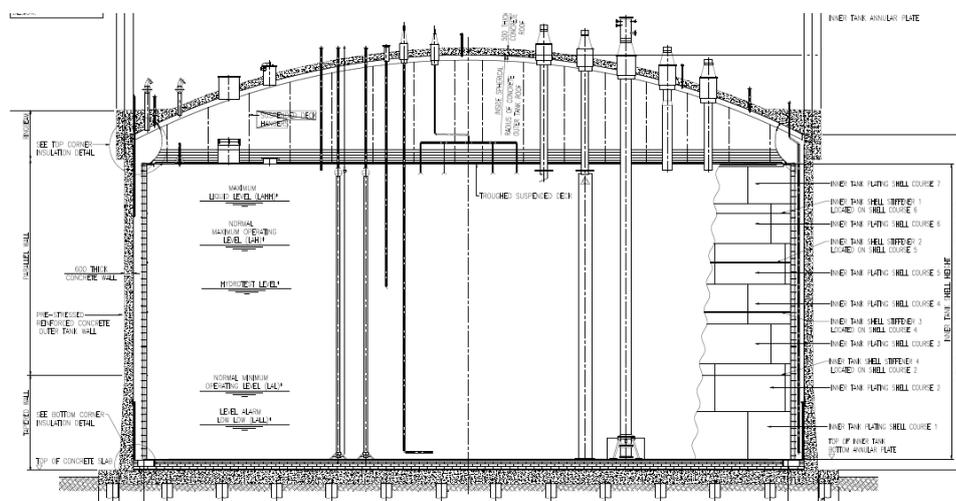
Figura 4.1: Serbatoio di Stoccaggio (Sezione)
