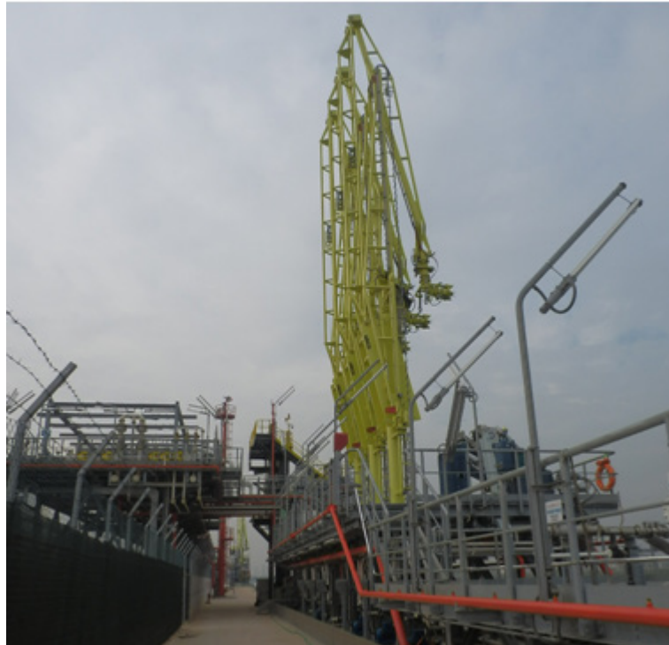
Figura 5.3: Bracci di Carico lungo la Banchina DECAL in prossimità dell'Area di Interesse
