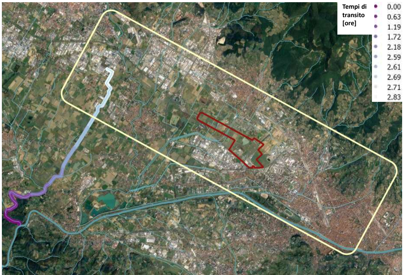
Figura 43 rappresentazione dei tempi di transito per il torrente VINGONE per una portata di deflusso pari a 20 m 3 /s.
