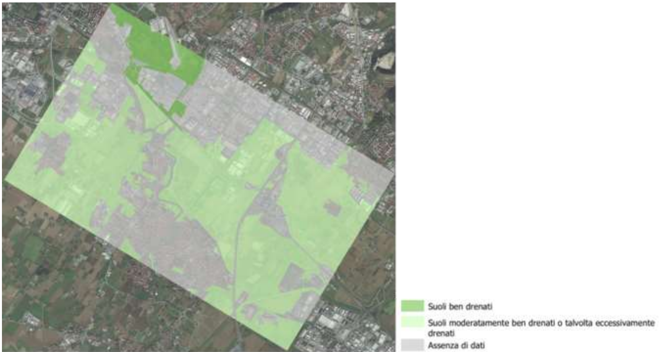
Figura 5-11 Drenaggio interno (Fonte: Regione Toscana)
