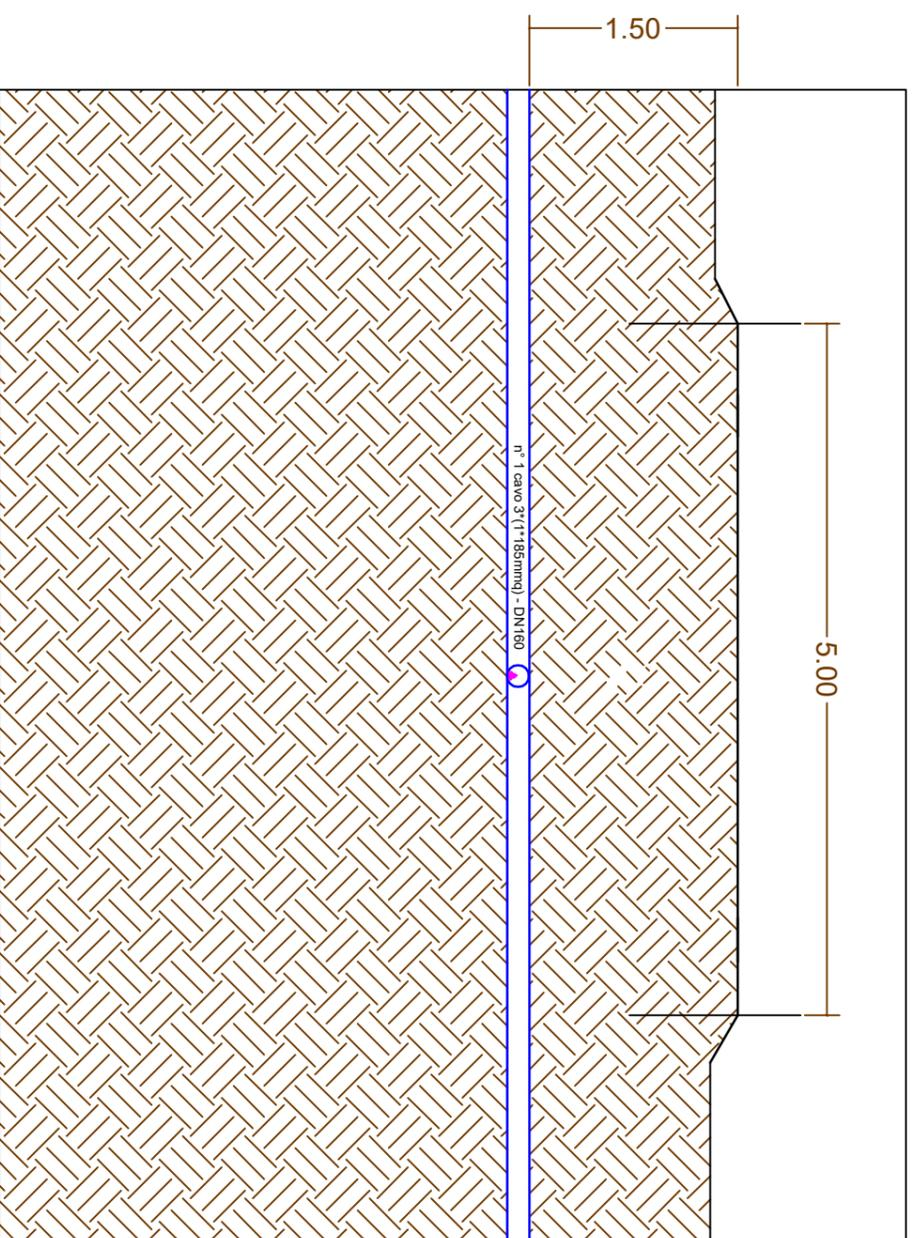
L'attraversamento del Regio Tratturello "Stornara Montemilone" avverrà ad una profondità di 1,50 m dal p.c., con una linea Al 185 mmq in cavo interrato mediante la tecnica del "no-dig", trasversalmente alla sede stradale esistente in terra battuta, temporaneamente ricoperta di massiciata in misto granulare (per uno spessore pari a 10 cm) al fine di consentire il transito dei mezzi di cantiere, da rimuovere al termine dell'uso senza lasciare modificazioni al sito.
