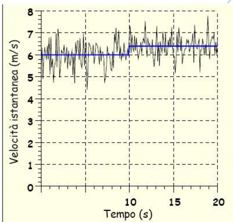
Ai fini della valutazione delle potenzialità energetiche dei siti eolici, viene di solito utilizzata una velocità del vento mediata su intervalli di tempo dell'ordine di 10 minuti.
