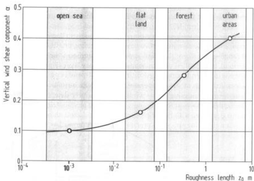
Attraverso la relazione che descrive il profilo verticale di velocità del vento è anche possibile effettuare una prima stima delle potenzialità anemometriche di siti fra loro vicini ma caratterizzati da diversa orografia. A tal fine si può infatti ipotizzare che la velocità del vento geostrofico si mantenga sostanzialmente costante in due siti vicini, in quanto si suppone che ad alta quota il vento non sia influenzato dall'orografia e dalla rugosità del suolo.
