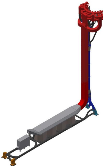
Figura 5.5a Modello 3D del sistema di circolazione dell'aria (in rosso il circuito dell'aria calda e in blu quello dell'aria fredda)
