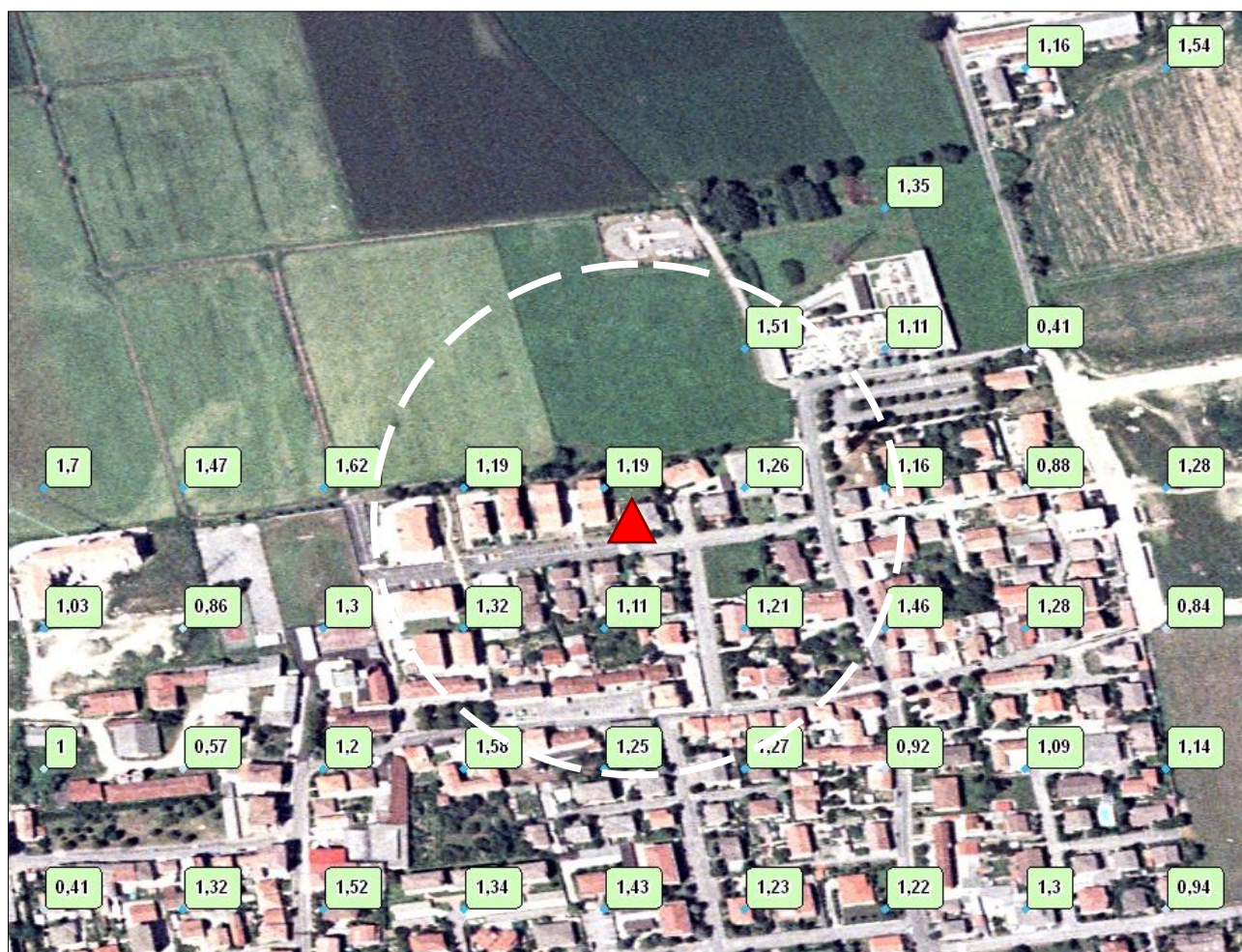
Fig.14 Visualizzazione del punto di riferimento utilizzato per la scomposizione LOCAL con indicazione dei punti REGIONAL più vicini. L'area per la quale è stata calcolata la media delle velocità verticali è delimitata da un cerchio avente un raggio di circa 150 metri.
