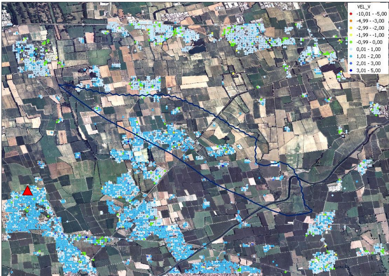
Fig.16 Visualizzazione in scala di colori dei valori di velocità verticale relativi all'analisi LOCAL dopo la variazione di +1.2 mm/anno effettuata sull'intero dataset. Il triangolo rosso indica la posizione del punto di riferimento utilizzato per la scomposizione del vettore velocità.
