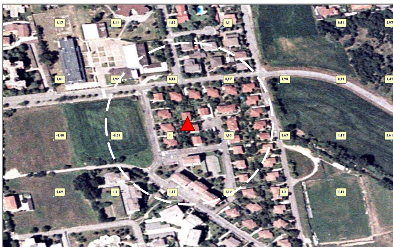
Fig.14 Visualizzazione del punto di riferimento utilizzato per la scomposizione LOCAL con indicazione dei punti REGIONAL più vicini. L'area per la quale è stata calcolata la media delle velocità verticali è delimitata da un cerchio avente un raggio di circa 150 metri.
