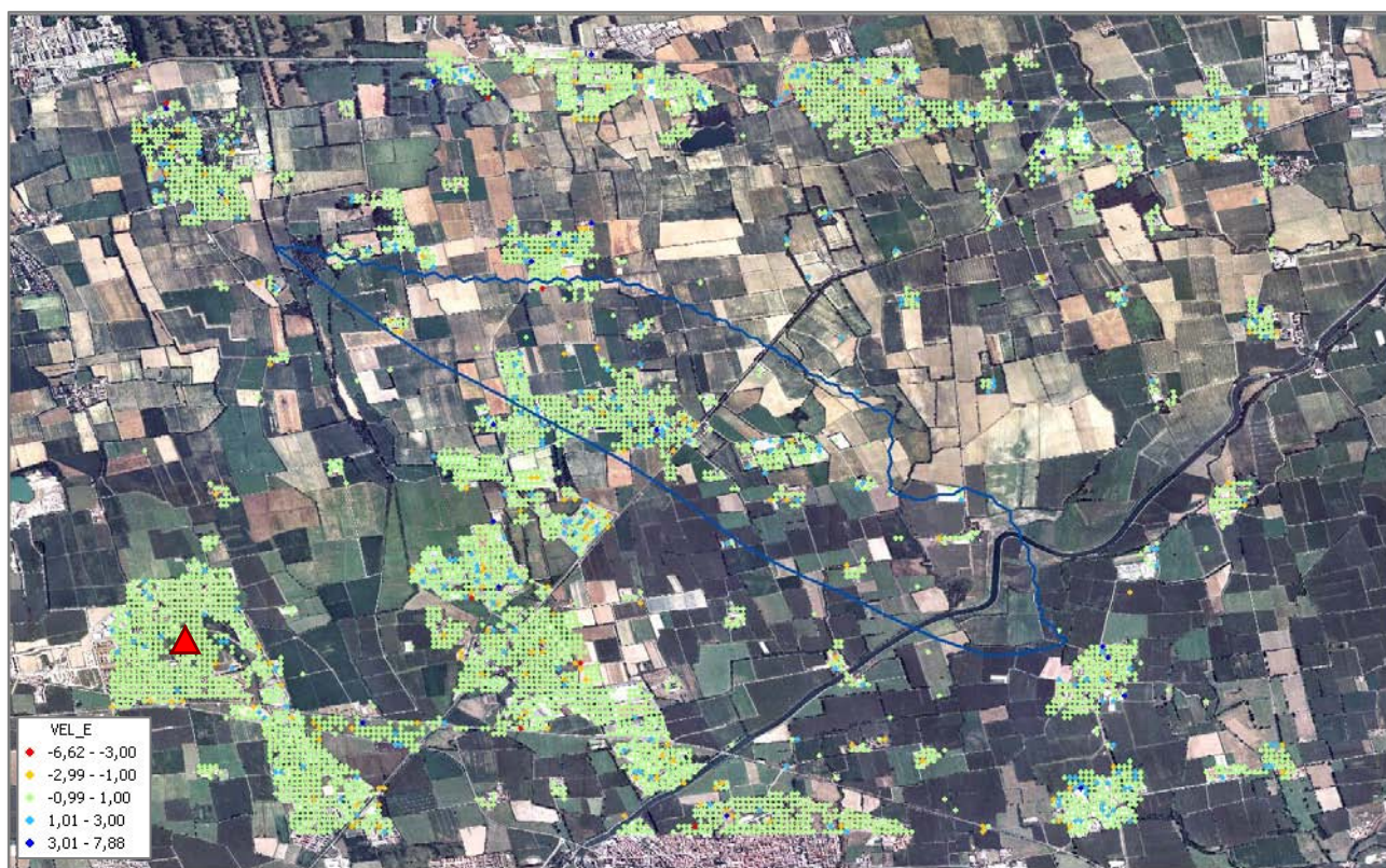
Fig.13 Visualizzazione in scala di colori delle velocità orizzontali dei punti scomposti del rilievo LOCAL.
