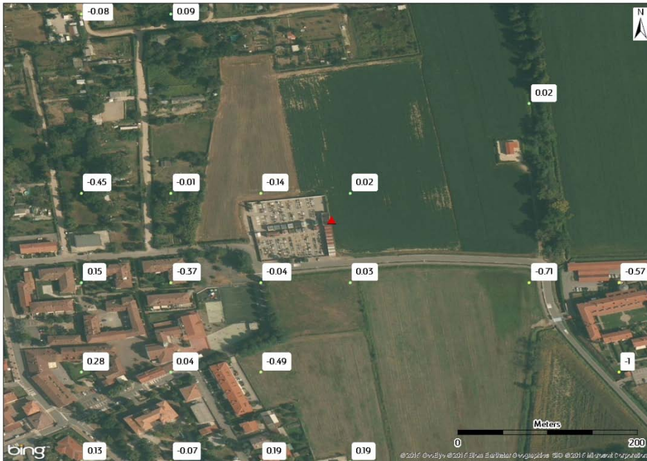
Fig.14 Visualizzazione del punto di riferimento utilizzato per la scomposizione LOCAL con indicazione dei punti REGIONAL più vicini. L'area per la quale è stata calcolata la media delle velocità verticali è delimitata da un cerchio avente un raggio di circa 150 metri.
