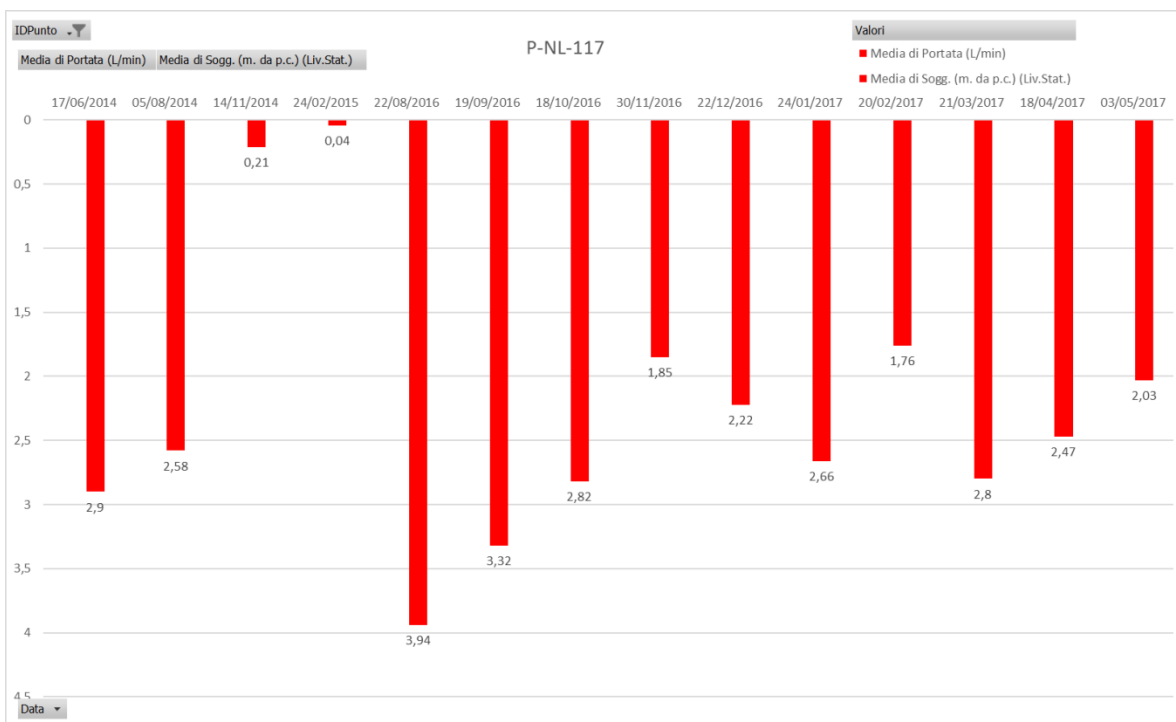
Figura 6.9 – Grafici riportanti i dati di soggiacenza dei punti di misura appartenenti alla WBS GN41 (Gall. Naturale Serravalle- Raccordo Tecnico III Valico) nel corso delle diverse campagne di misura realizzate.
