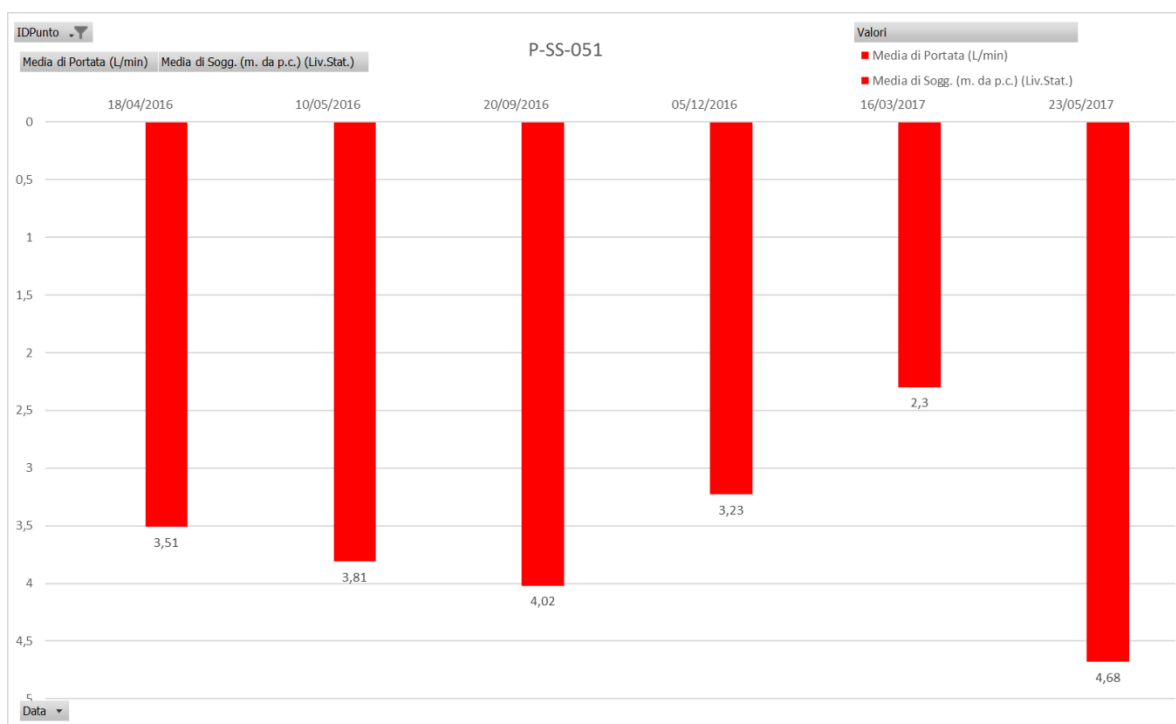
Figura 6.8 – Grafici riportanti i dati di soggiacenza dei punti di misura appartenenti al gruppo di WBS GN1BA-GN1CA-GN1Y (Galleria Serravalle) nel corso delle diverse campagne di misura realizzate.
