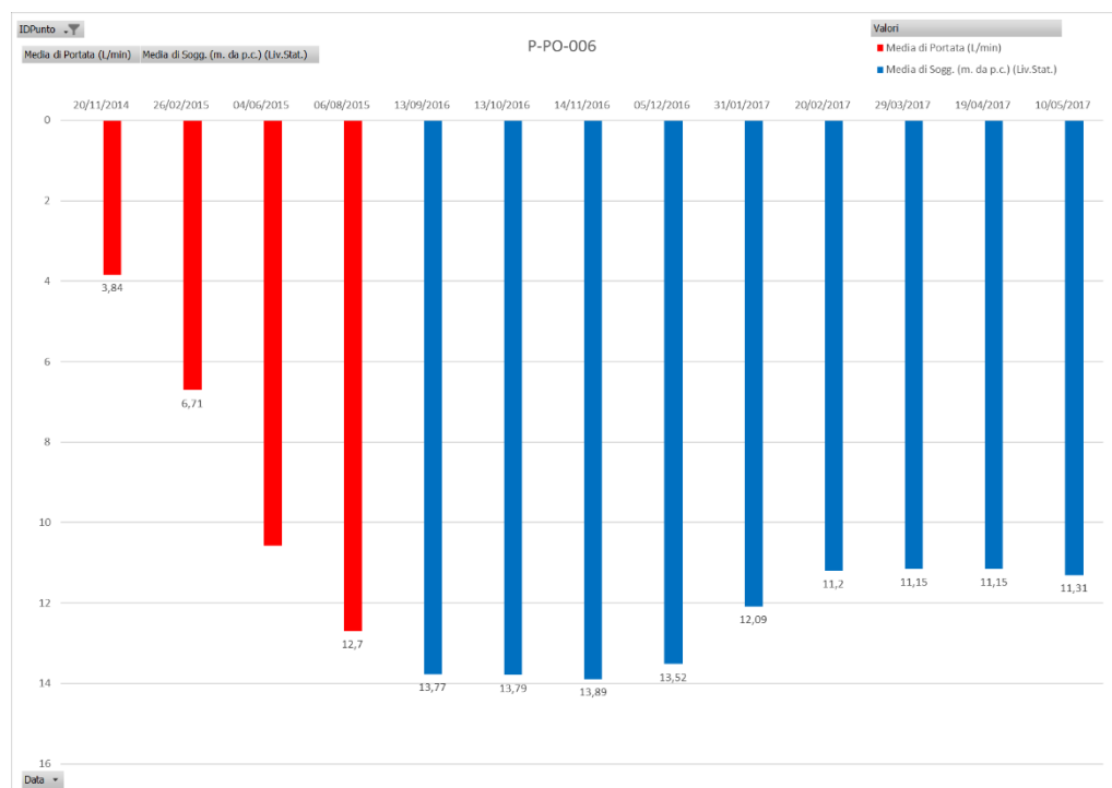
Figura 6.32 – Grafico riportante i dati della soggiacenza del punto di misura appartenente alle WBS TR14-GA1M nel corso delle diverse campagne di misura realizzate (in rosso sono riportate le campagne realizzate in fase di Ante Operam e in azzurro quelle in Corso d’Opera).
