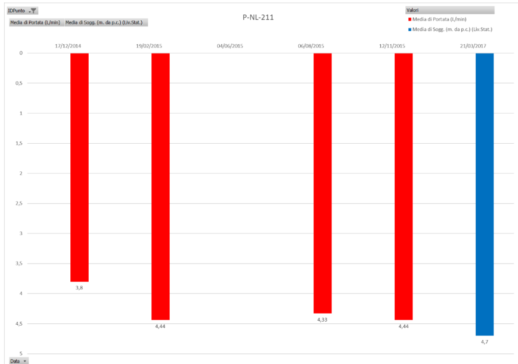
Figura 6.20 – Grafico riportante i dati della soggiacenza dei punti di misura appartenenti al gruppo di WBS GN1CB-BB-GN1Y-COP6 (Valle) nel corso delle diverse campagne di misura realizzate (in rosso sono riportate le campagne realizzate in fase di Ante Operam e in azzurro quelle in Corso d’Opera).
