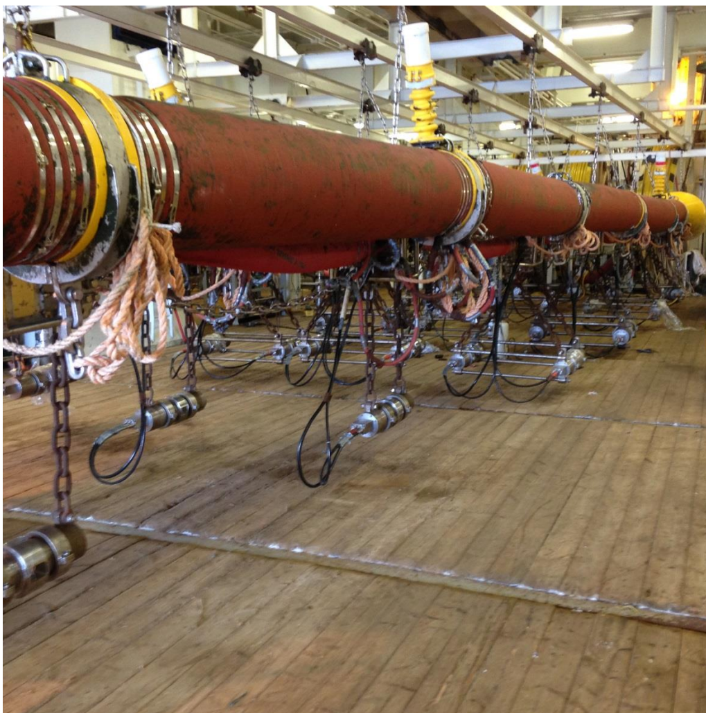
Figura 3.1.2c. Tipico Gun array sul ponte inferiore in attesa di essere posto in acqua (fonte Edison)
