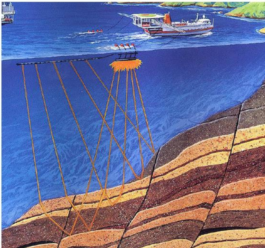
Figura 3.1b: esempio di stendimento e linea di acquisizione sismica a mare (AAPG)
