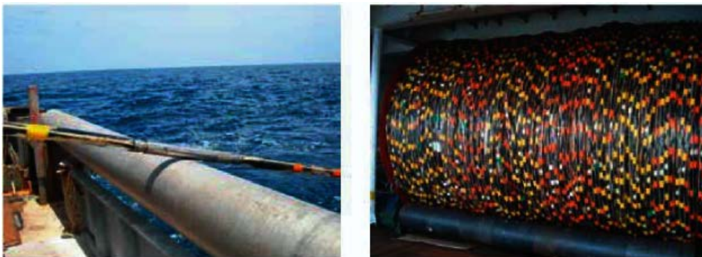
FIGURA 2.19: ESEMPIO DI CAVO SISMICO O STREAMER (OGP, 2011)
