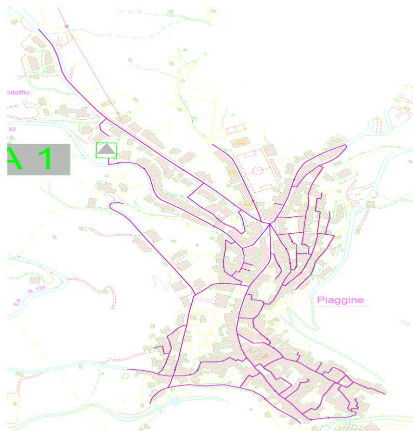
Piaggine rete di distribuzione gas naturale in bassa pressione
