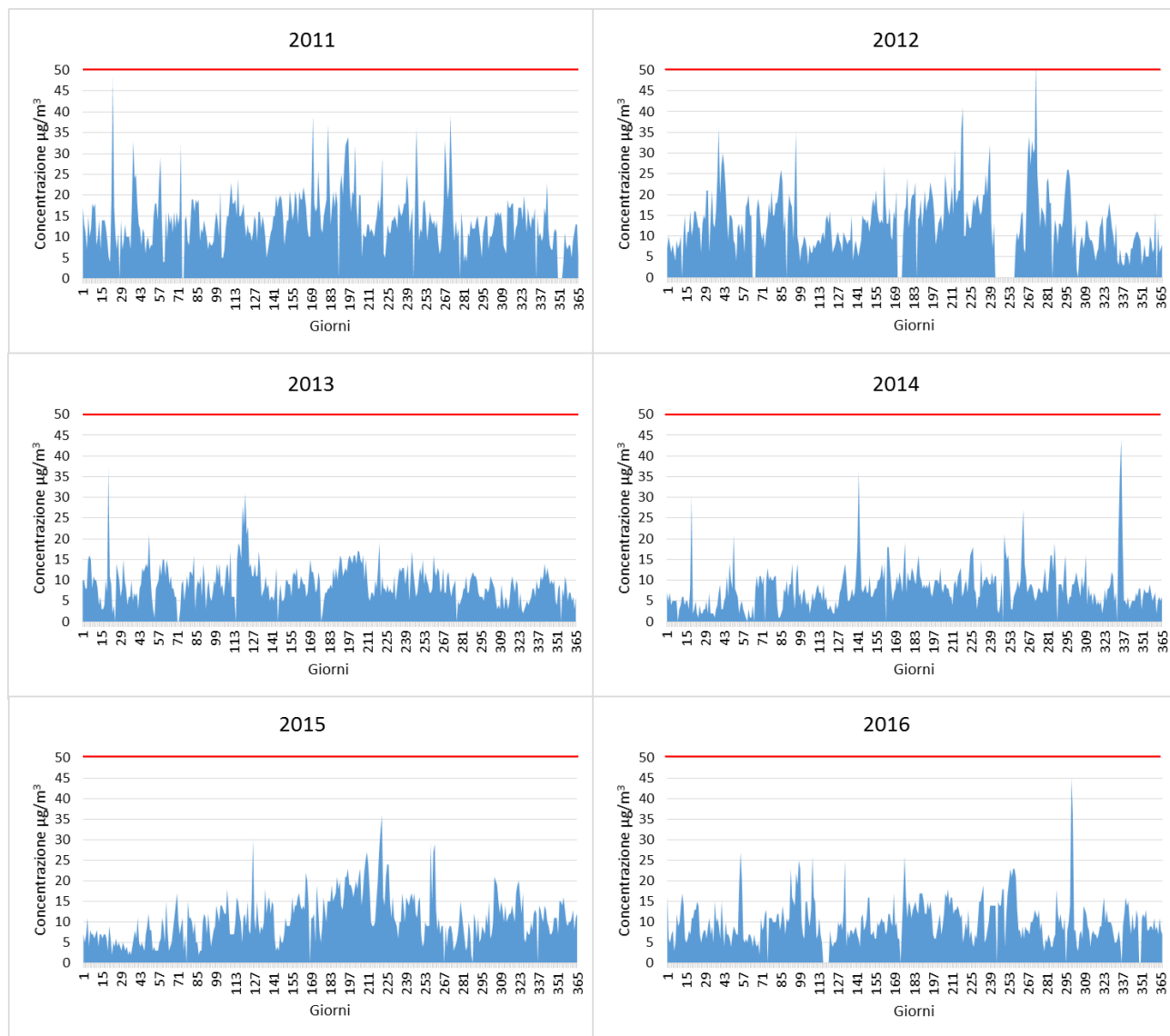
Figura 4-90 Valori giornalieri di PM10 anni 2011-2016 Stazione di PI - MONTECERBOLI fonte: elaborazione dati ARPAT
