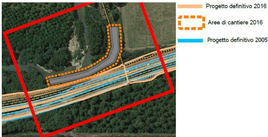
Figura 4-53 Opera di protezione spondale sull'ansa del Fiume Merse (in grigio)
