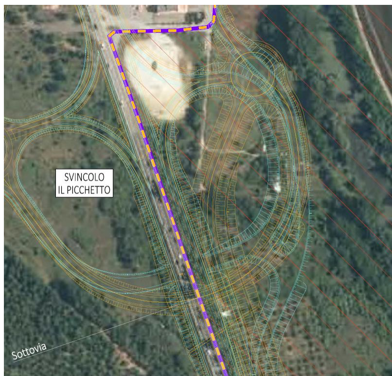
Figura 8.6 Estratto dell'ambito 3, le rampe di svincolo Il Picchetto (in giallo il progetto 2016 e in azzurro il progetto 2005)
