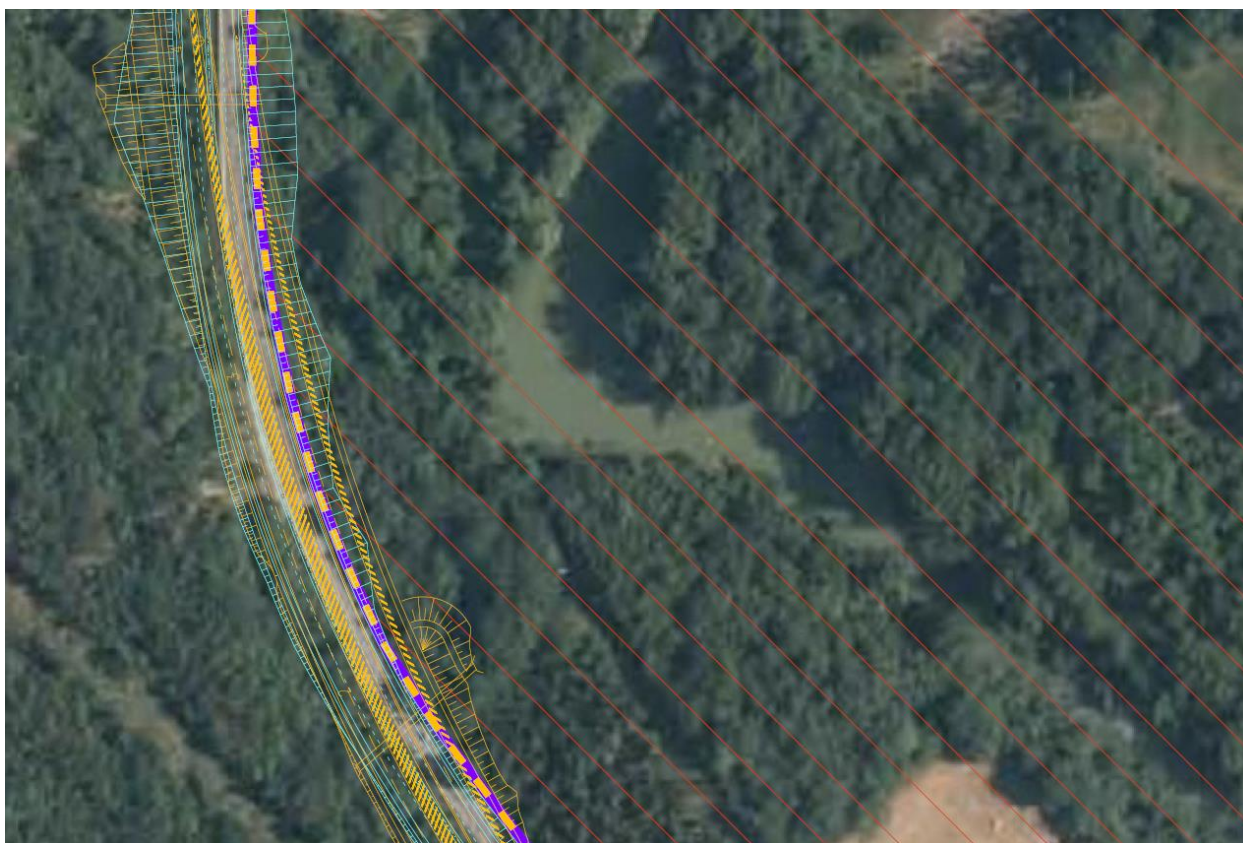
Figura 8.4 Estratto dell'ambito 2 con rettifica della curva in dx (in giallo il progetto2016 e in azzurro il progetto 2005)
