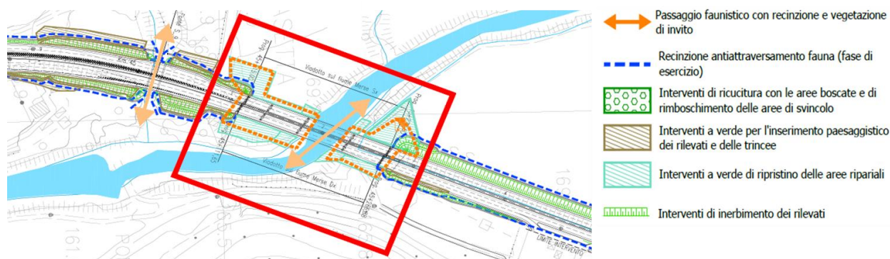
Figura 10.21 Interventi di inserimento paesaggistico-ambientale in prossimità del viadotto sul Fiume Merse
