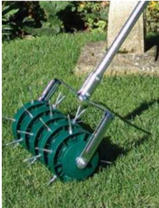
**Fig. 5.12- Esempio di arieggiatore manuale per prati**
