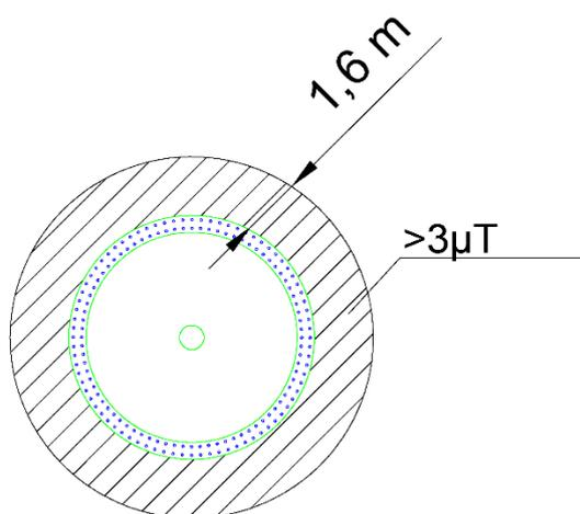
Figura 1 – valore di induzione magnetica nell'intorno della torre in acciaio
