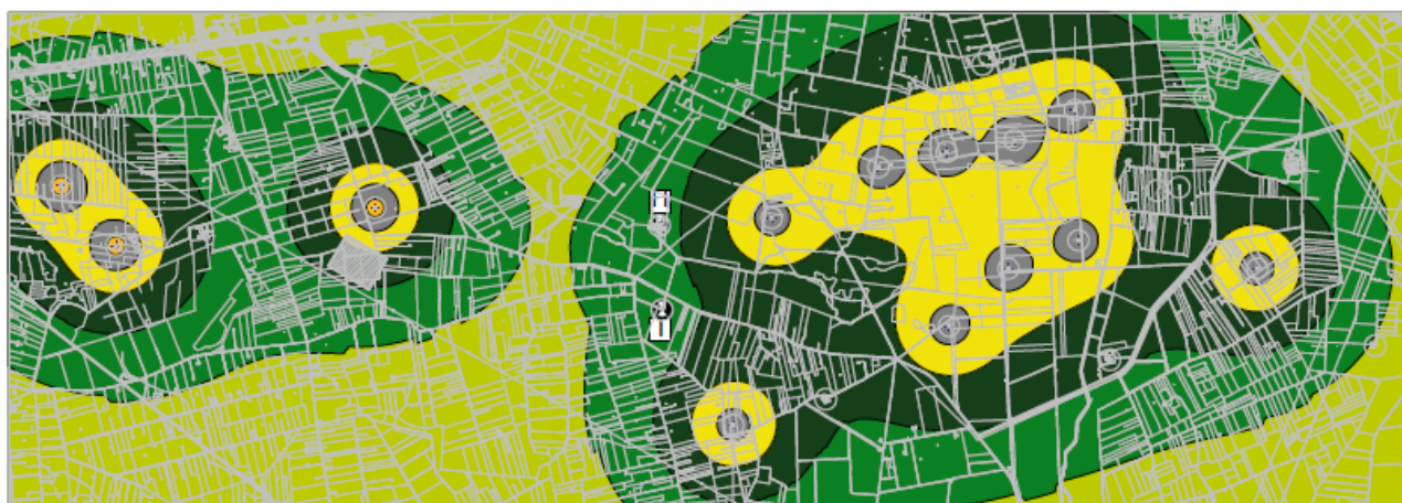
Figura 7 – Mappa con isofoniche Impatto acustico cumulativo tra parco eolico in progetto (a sinistra) ed i tre aerogeneratori più vicini del parco eolico Eolica Erchie (a destra)
