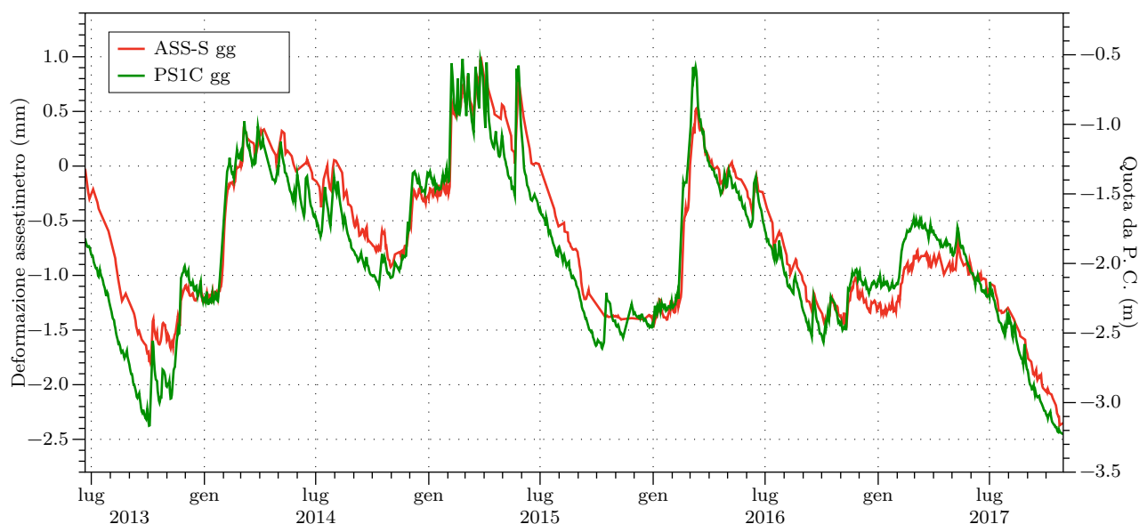
Figura 3.9: Relazione tra le deformazioni giornaliere medie registrate lungo l'asta dell'assestmetro superficiale (ASS-S) e le oscillazioni di quota nel piezometro superficiale PS1C, durante l'intero periodo di monitoraggio.
