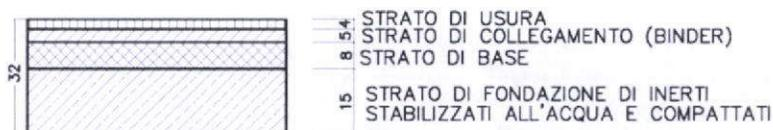
Figura 4 – Particolare pacchetto pavimentazione
