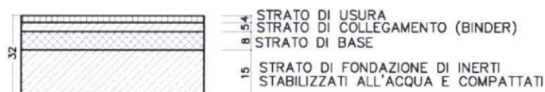
Figura 8 – Particolare pacchetto pavimentazione
