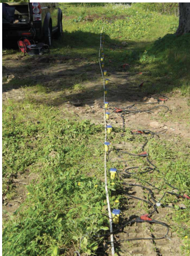
Foto 5 Particolare della stesa geofonica.
