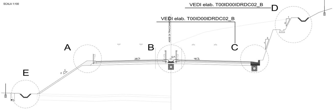
**ASSE PRINCIPALE - SEZIONE IN RILEVATO - SISTEMA CHIUSO**
