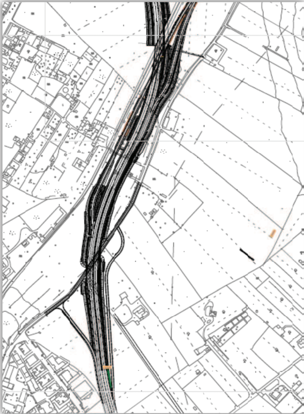
Fig. 4 – Intersezione con via Ungias – Svincolo parziale
