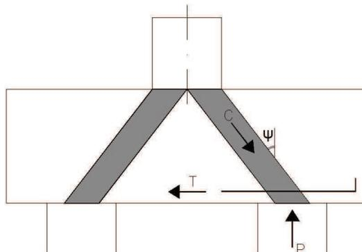
Il meccanismo resistente è costituito da un tirante orizzontale, corrispondente all'armatura tesa, e da un puntone di calcestruzzo inclinato di  $\Psi$  che riporta il carico  $P_{ed}$ .
