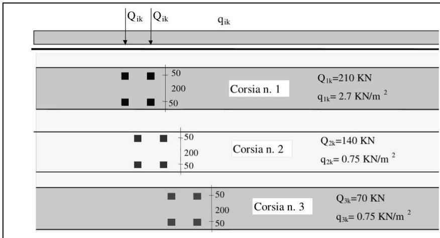
**Figura 5.1.4 – Modello di carico di fatica n. 1**
