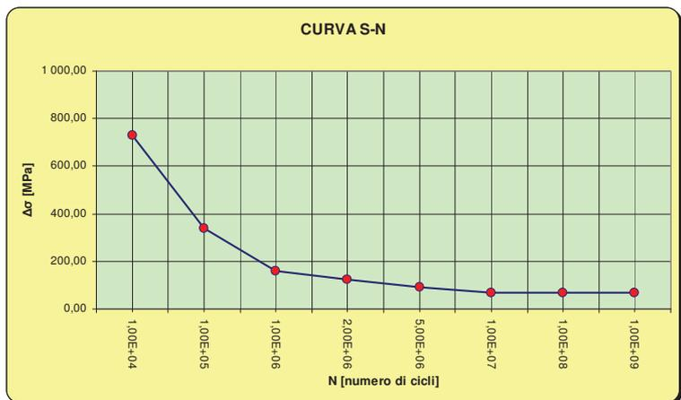
Il valore del limite di fatica ad ampiezza costante utilizzato nelle verifiche delle piattabande è assunto pari a:
