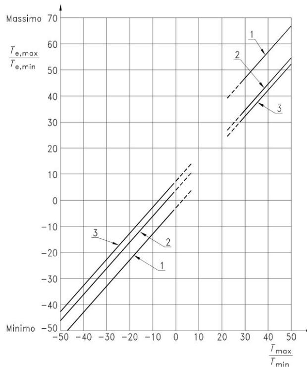
Nel caso specifico si fa riferimento alla curva Tipo 2 “Impalcato a struttura composta” visto che l’impalcato oggetto di studio è a sezione composta acciaio-calcestruzzo.
