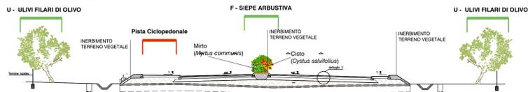
Sezione tipo Asse principale Bretella di collegamento con l'Aeroporto di Fertilia - Rilevato
