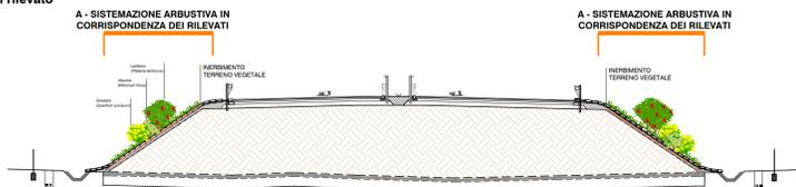
Sezione tipo Circonvallazione Alghero - in rilevato con marciapiedi laterali - tratto compreso tra Rotatoria 2 e Rotatoria 3
