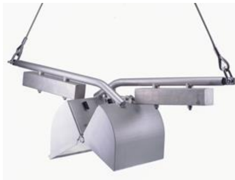
Figura 8 Benna Van Veen per il campionamento delle biocenosi di substrato molle
