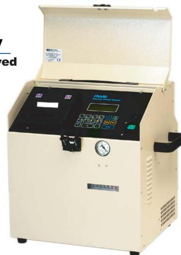
Il modello CHARLIE HV, con portata d'esercizio da 10 a 50 l/min, è adatto ad operare specificatamente per le polveri, ed in particolare con la testa di prelievo LVS PM10 2.3 m<sup>3</sup>/h secondo la norma EN 12341.
