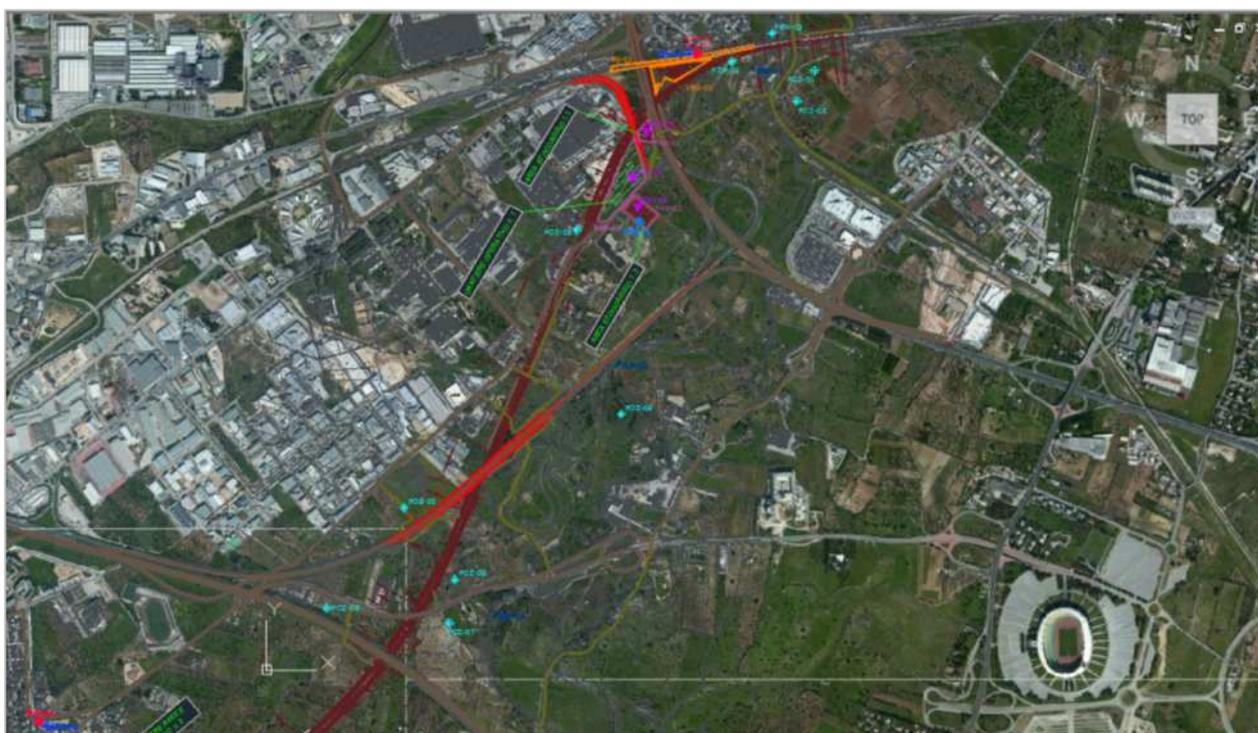
A seguito di un rettilineo di 94 m di lunghezza ha quindi inizio il tratto in variante con una lunghezza verso sinistra di raggio pari a 750 m, progettata per una velocità di percorrenza di 100 km/h: nella parte iniziale, il tratto in questione inizia a discostarsi dalla linea esistente cosicché in corrispondenza della lama "Lamasinata" è previsto un intervento di prolungamento dell'attuale ponte (km 4+468).
