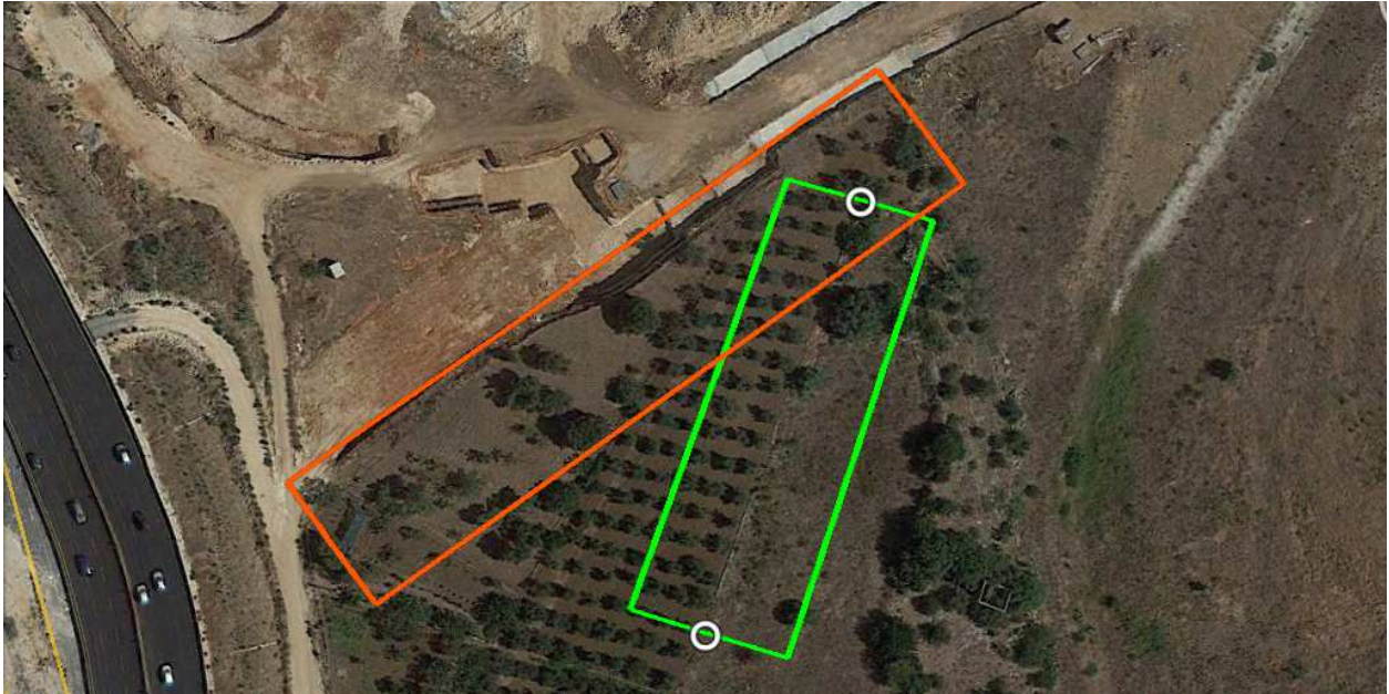
Stazione VEG-1/VEG-2 – Monitoraggio fasce campione: collocazione della fascia prossimale (in arancione) e distale (in verde); sono riportati i punti d'inizio e di fine dei transetti di rilevamento della fascia distale (cerchi semplici); la fascia prossimale segue l'andamento del margine dell'area di cantiere.
